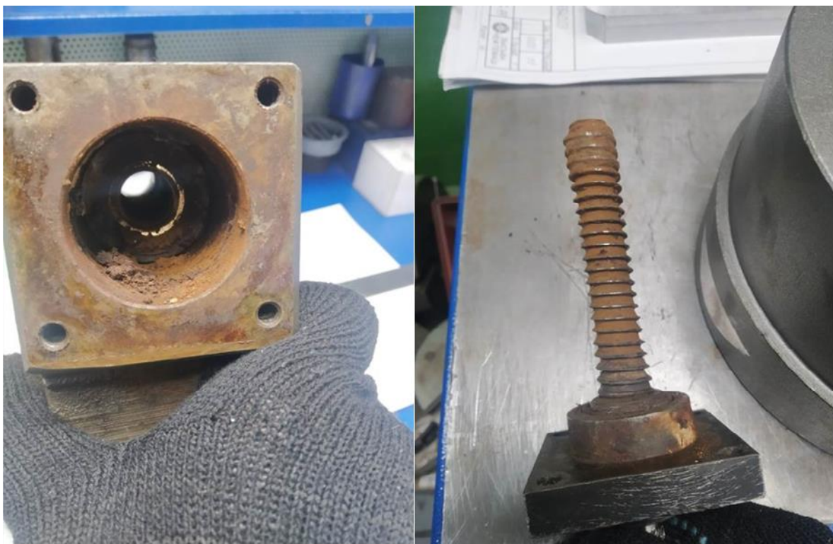
Рис. 2. Коррозия и износ рабочих поверхностей
